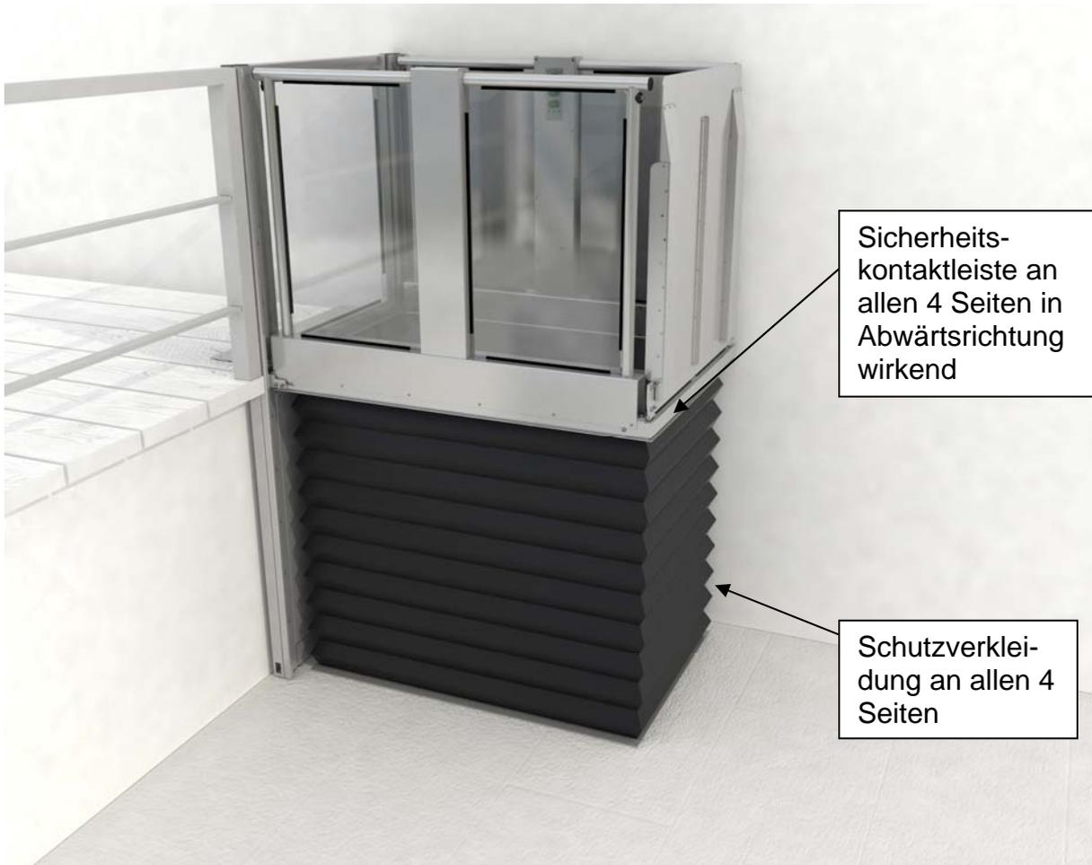
Die Hebebühne ist mit einer Sicherheitsverkleidung (Faltenbalg) an allen 4 Seiten ausgestattet. Darüber hinaus befindet sich seitlich am Plattformboden eine Sicherheitskontaktleiste, welche beim „AB“-Fahren im Falle eines vorhandenen Hindernisses gedrückt wird und die Fahrt unterbricht.
