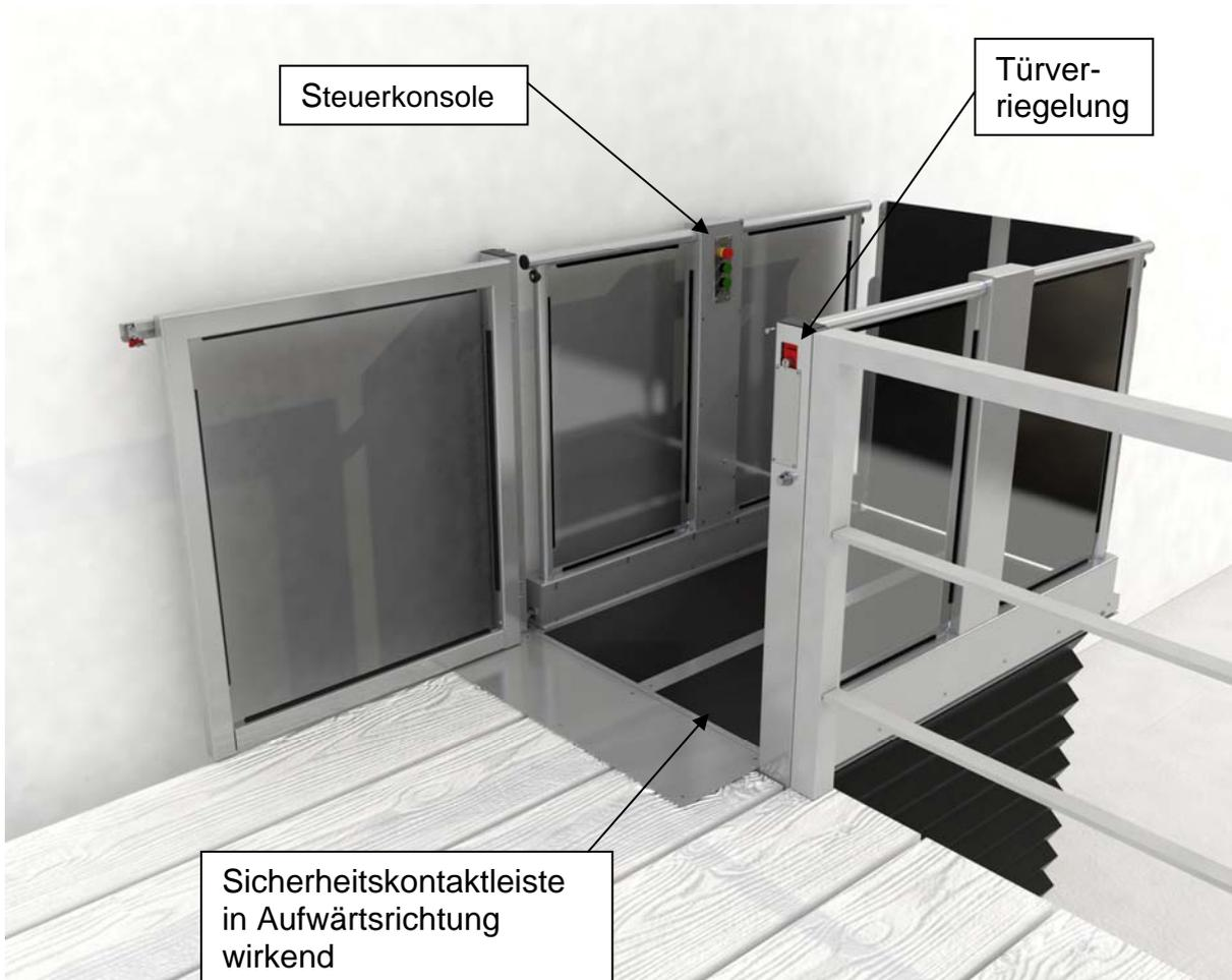
Beim Erreichen der oberen Halteposition entriegelt sich die Tür automatisch. Die Tür kann nun vom Benutzer geöffnet werden. Nachdem die Tür wieder geschlossen wird, verriegelt sie sich automatisch.
