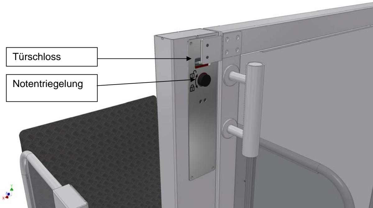
Alle Drehtüren sind mit einer Notentriegelung ausgestattet. Das Notentriegelungswerkzeug kann entweder als „Notentriegelungsschüssel“, als spezieller „Inbusschlüssel“ oder als „Dreikantschlüssel“ ausgeführt sein.
