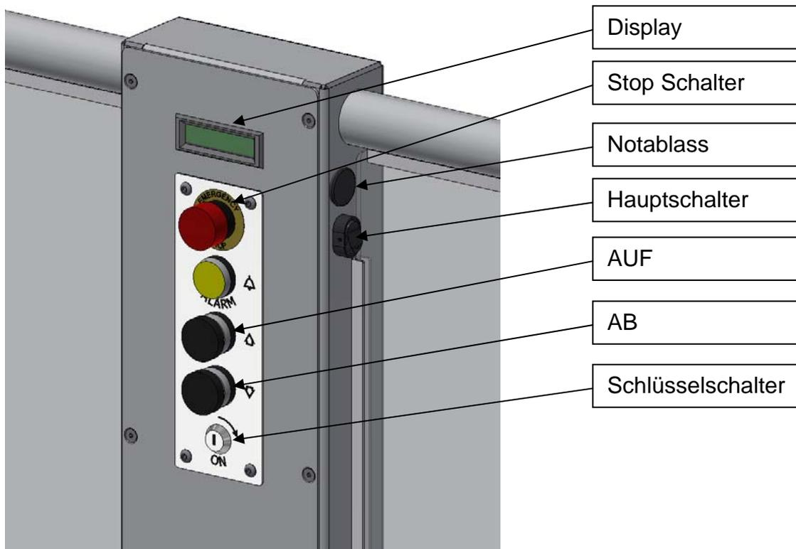
Die Steuerkonsole auf der Plattform ist zur Bedienung der Hebebühne und besitzt eine Displayanzeige, die Aktivität der Hebebühne, Überlast und Batteriekapazität überwacht.
